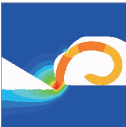
Neues Zahndesign mit Spanleitstufe
