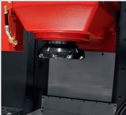
Fräskopf Durchmesser 200 mm
