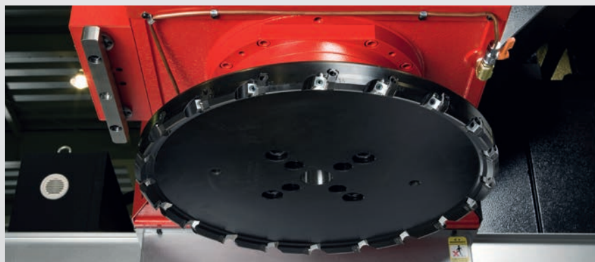
Fräskopf Ø 525 mm
